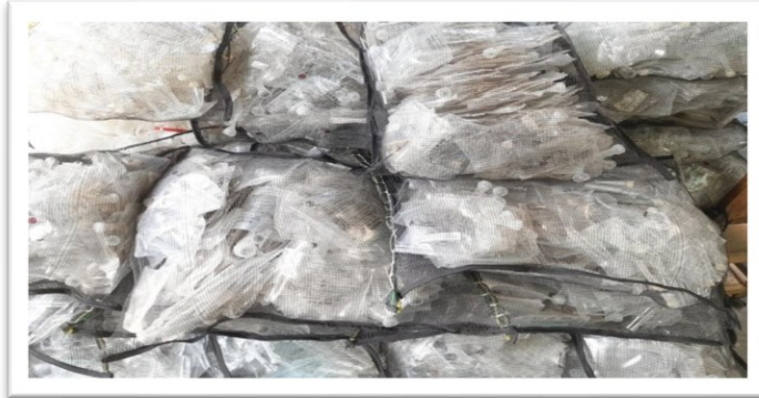
Gambar 4. Pengemasan Cacahan plastik bekas sebagai media biofilter
