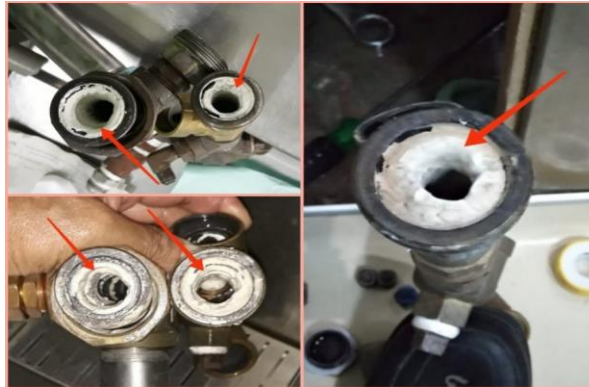
Gambar 4.2 Kondisi Alat Akibat Kualitas Air Kurang Baik
