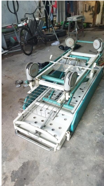
Gambar 2. Proses perakitan stretcher motor elektrik
