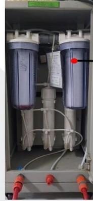
Filter Yang Di improve pada Mesin RO Portable
