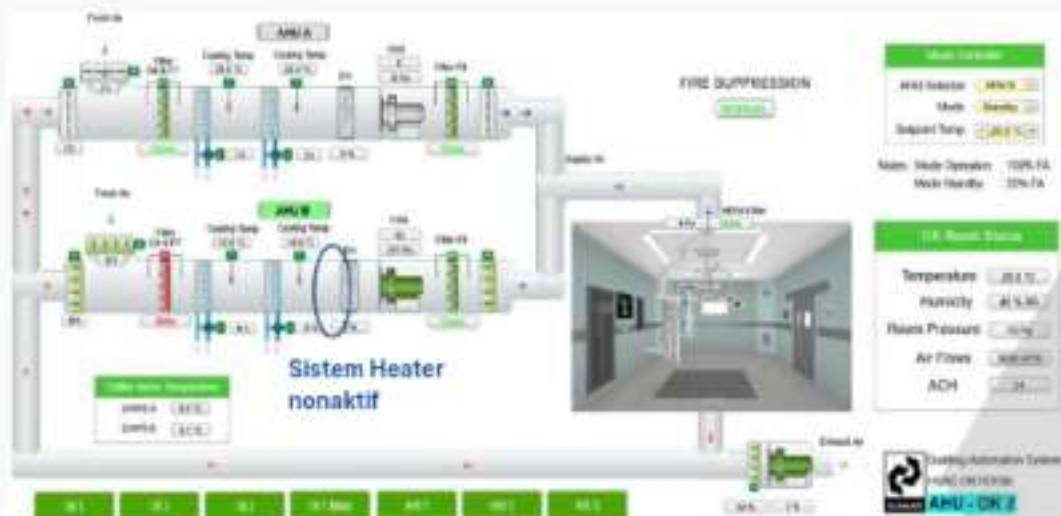
Gambar 7. Tampilan utilisasi heating controller system melalui BAS untuk Operating Theater Air Handling Unit
