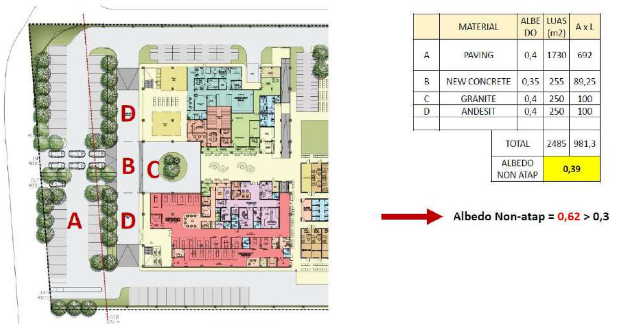
Foto 5. Lokasi bangunan yang menggunakan material untuk menghindari efek heat island pada area non atap gedung sehingga nilai albedo minimum 0,3 sesuai perhitungan
